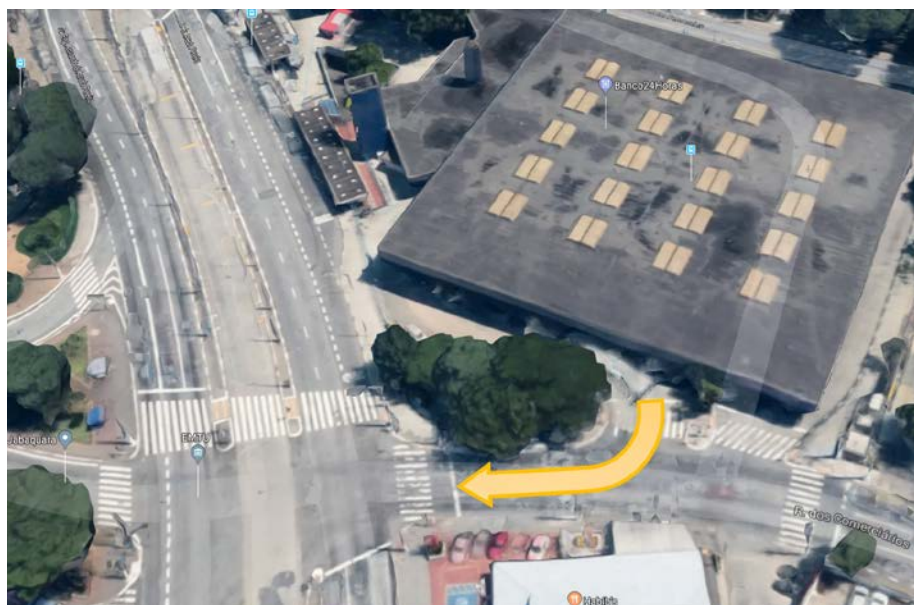
Figura 8 - Saída problemática pois a caixa de acumulação é curta
